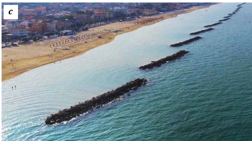
Р и с. 2. Примеры защиты берега при помощи природного камня: a – откосные береговые укрепления, штат Орегон (США); b – откосные береговые укрепления из камня, Кипр; c – волноломы на Адриатическом побережье Италии
