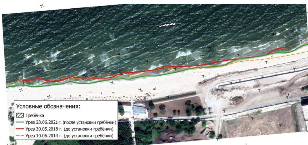
Р и с. 6. Межгодовая динамика уреза в районе волнолома до и после его установки (источник данных за 2014 г. – GoogleEarth , 2018 г. – снимок со спутника «Ресурс-П», 2021 г. – GPS -трассировка)
