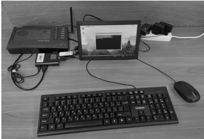
Р и с . 1. Внешний вид рабочего места проведения измерений в автоматическом режиме, а также передачи и хранения данных метеостанции *Davis Vantage Pro 2* с использованием АПК *Raspberry Pi B+*
