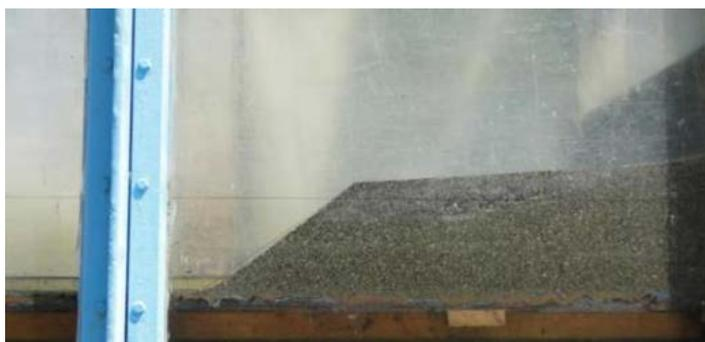
Рис. 4. Модель исходной отсыпки пляжеобразующего материала. Горизонтальной линией показан уровень воды при приливе
