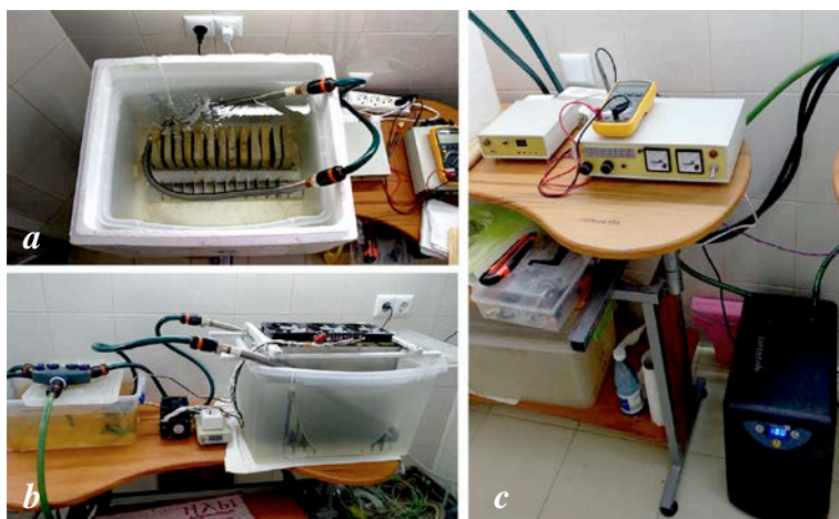
Рис. 1. Длительный эксперимент в лабораторных условиях: a – КК с пластинами из бетона и стали; b – ЭК с УЗУ и такими же пластинами; c – приборы для регулирования временного и мощностного режима работы УЗУ ( сверху ) и устройство для охлаждения и термостатирования HAILEA ( снизу )
