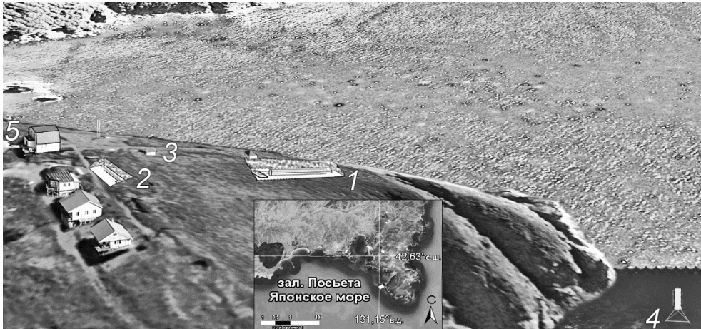
Р и с. 2. Схема расположения лазерных интерферометров: 1 – лазерный деформограф с длиной измерительного плеча 52,5 м; 2 – лазерный деформограф с длиной измерительного плеча 17,5 м; 3 – лазерный нанобарограф; 4 – лазерный измеритель вариаций давления гидросферы; 5 – лабораторное помещение
