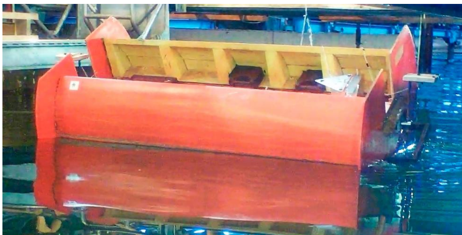
Р и с. 11. Испытание модели в опытовом волновом бассейне под воздействием волн Fig. 11. Model during wave tests in the experimental wave basin
