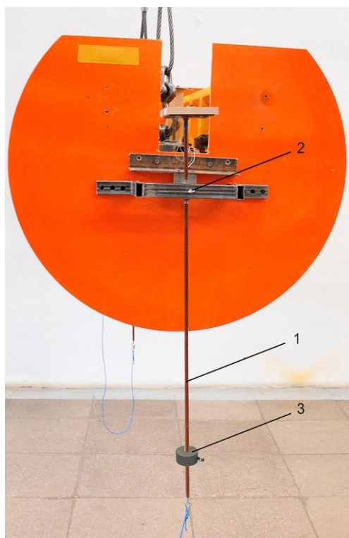
Р и с. 8. Одна из двух маятниковых систем, закрепленных по бокам модели: 1 – штанга; 2 – ось поворота штанги; закрепленной на оси центра масс модели; 3 – перемещаемый вдоль штанги груз с винтовым прижимом
